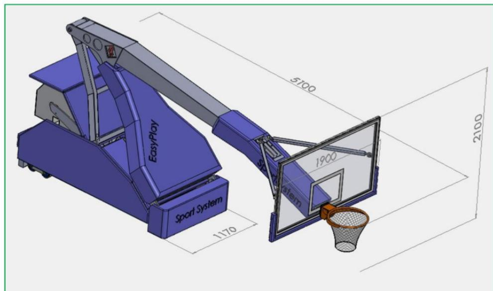
NB : mesures observées roues au sol, avec roues relevées la hauteur de la butée arrière diminue de 35 mm.
