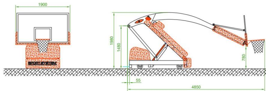
NB : mesures observées avec les roues surélevées, avec les roues au sol la hauteur de la butée augmente de 45 mm.
