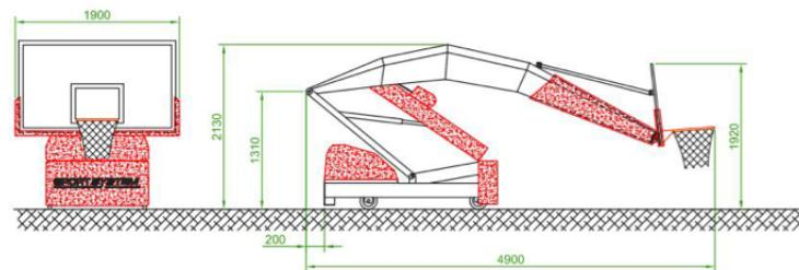
NB : mesures observées roues au sol, avec roues relevées la hauteur de la butée arrière diminue de 50 mm.
